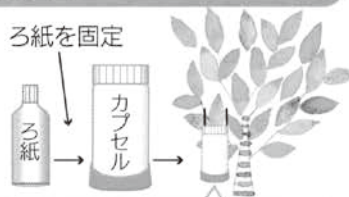
専用シートに貼りつけて、カプセルの底をはずし測定場所に24時間つるします。
